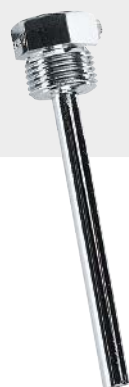
THR -ms-08 / xx Погружная гильза из никелированной латуни с уплотнением резьбы, коническая, согласно DIN 10226
