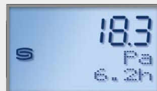
Настройка калибровки нуля Время цикла (от 15 мин до 24 ч) настраивается с помощью потенциометра
