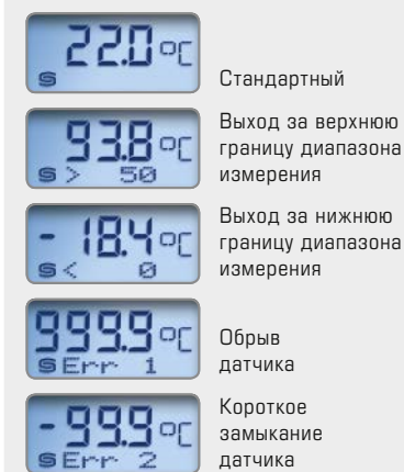
Индикация и самодиагностика THERMASGARD® Измерительный преобразователь
